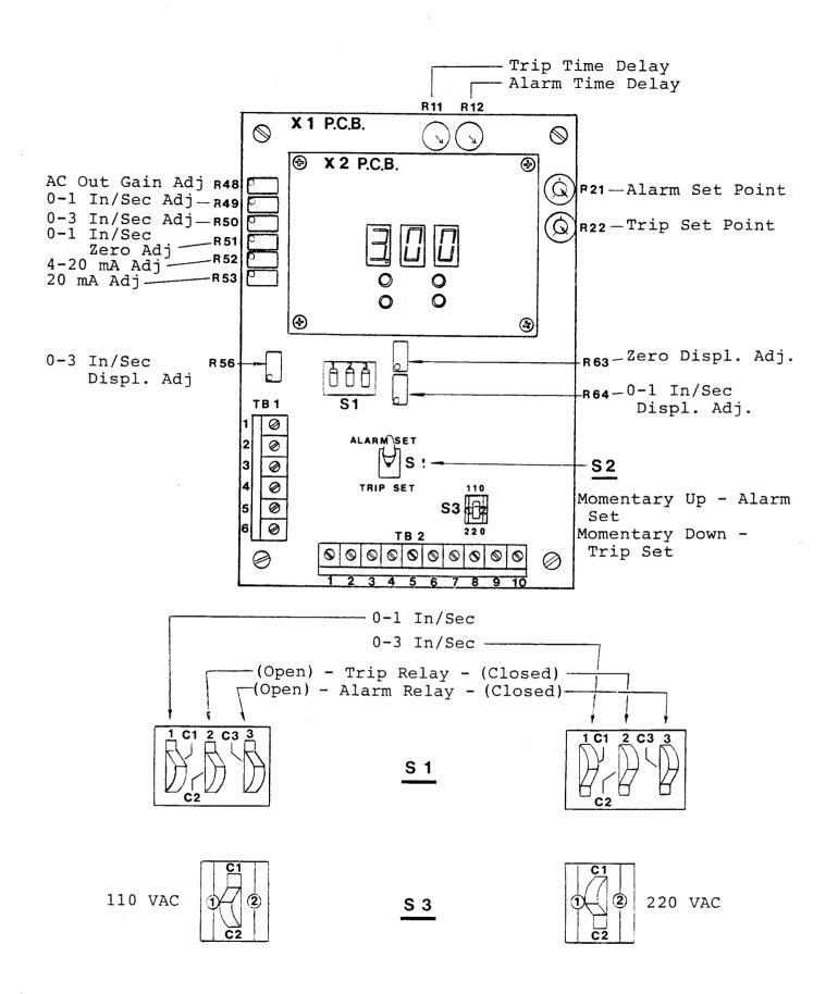
FIGURE 1 COMPONENT LOCATION AND IDENTIFICATION OVERVIEW
